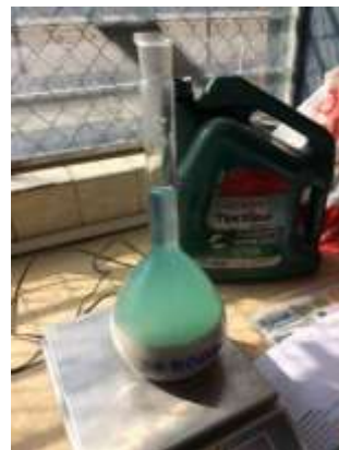
Gráfico 16. Ensayo Densidad Real del Cemento Fuente: Egdo. Christian Javier Revelo A.
