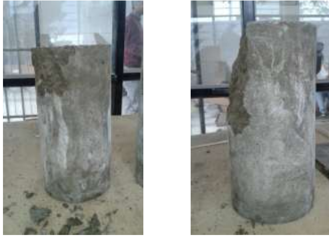
Gráfico 23. Falla Tipo 5(Fractura al lado extremo superior) Probeta de Hormigón – Mescla 1 Fuente: Egdo. Christian Javier Revelo A.
