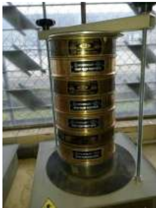
Gráfico 12. Ensayo Granulométrico agregado fino y grueso Fuente: Egdo. Christian Javier Revelo A.
