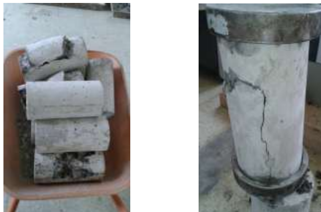
Gráfico 22. Probetas Ensayadas de Hormigón Fuente: Egdo. Christian Javier Revelo A.
