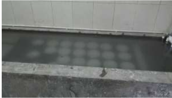
Gráfico 20. Curado Probetas de Hormigón Fuente: Egdo. Christian Javier Revelo A.
