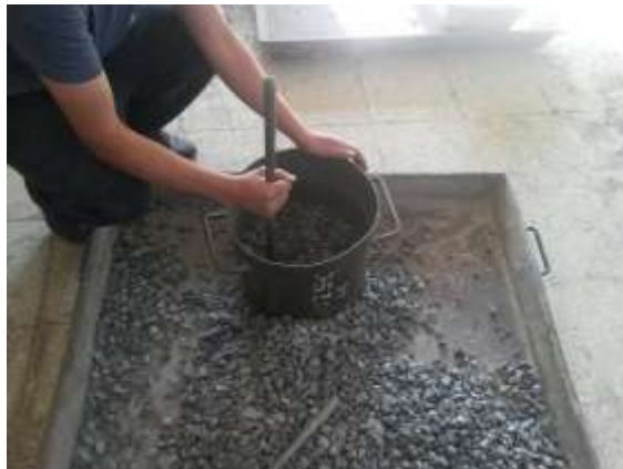
Gráfico 13. Ensayo Densidad Aparente Fuente: Egdo. Christian Javier Revelo A.
