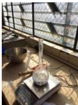
Gráfico 16. Ensayo Densidad Real del Cemento Fuente: Egdo. Christian Javier Revelo A.
