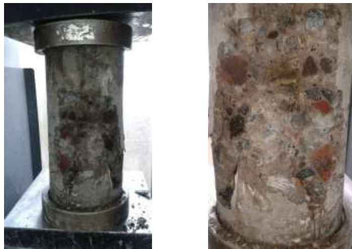
Gráfico 24. Falla Tipo 3(Fisura vertical columna a través de ambos extremos) Probeta de Hormigón – Mescla 2 Fuente: Egdo. Christian Javier Revelo A.
