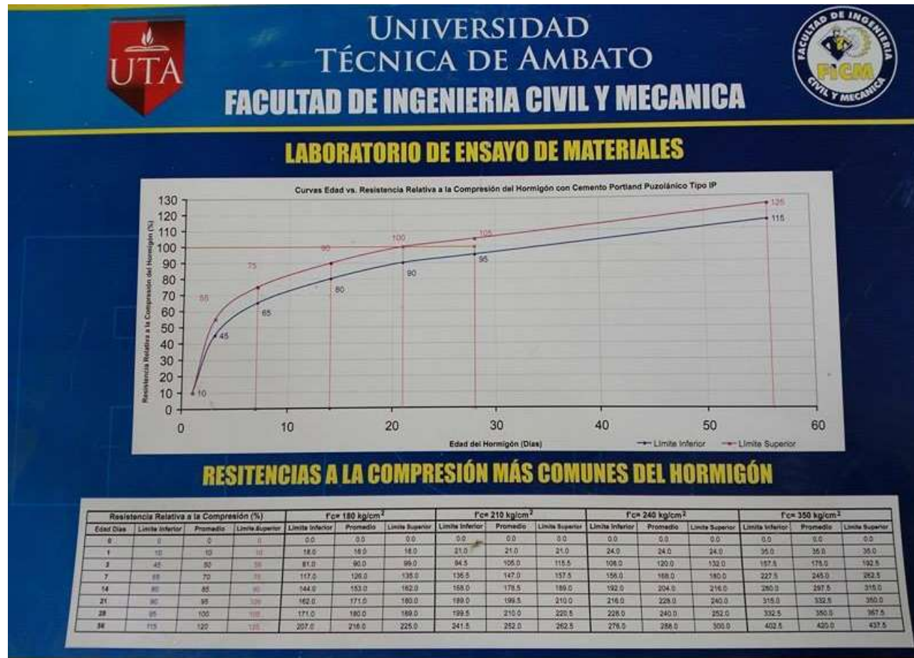
Gráfico 27. Resistencia a la Compresión más Comunes del Hormigón Fuente: Laboratorio de Ensayo de Materiales, FICM-UTA
