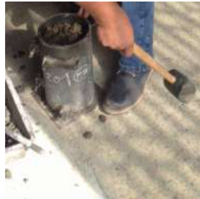
Gráfico 18. Preparación de Probetas de Hormigón Fuente: Egdo. Christian Javier Revelo A.
