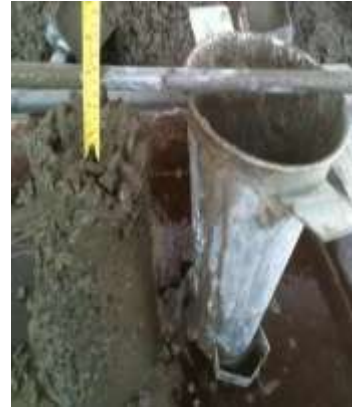
Gráfico 17. Ensayo Cono de Abrams Fuente: Egdo. Christian Javier Revelo A.
