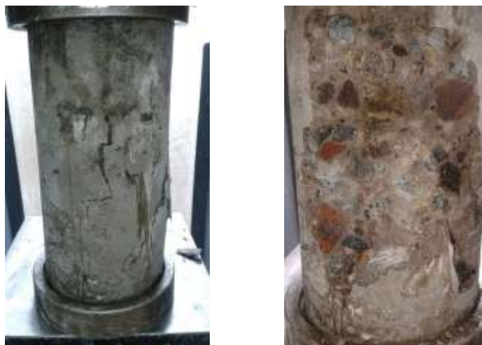
Gráfico 26. Falla Tipo 3(Fisura vertical columna a través de ambos extremos) Probeta de Hormigón – Mescla 4 Fuente: Egdo. Christian Javier Revelo A.
