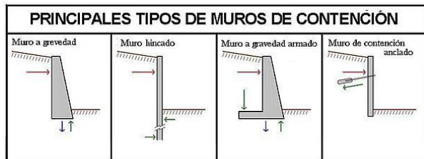
Figura 4. Tipos de muros de contención
