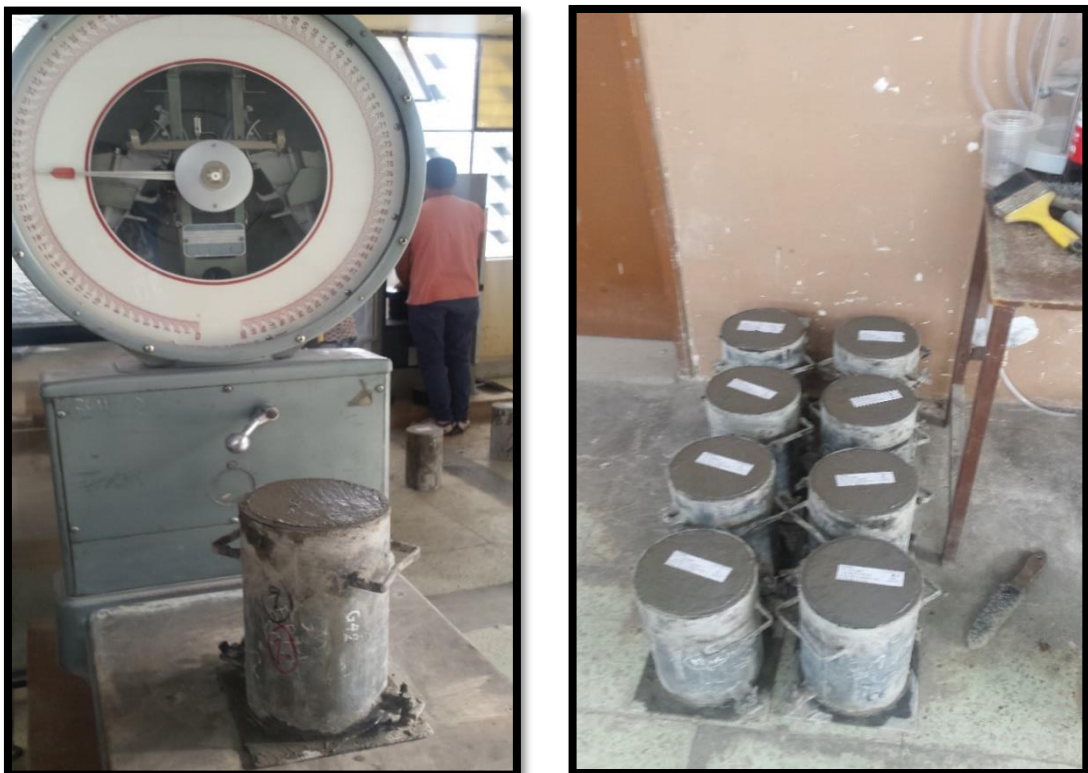
Fotografía 12. Determinación del peso de los cilindros. Fuente: Egda. Johana Núñez
