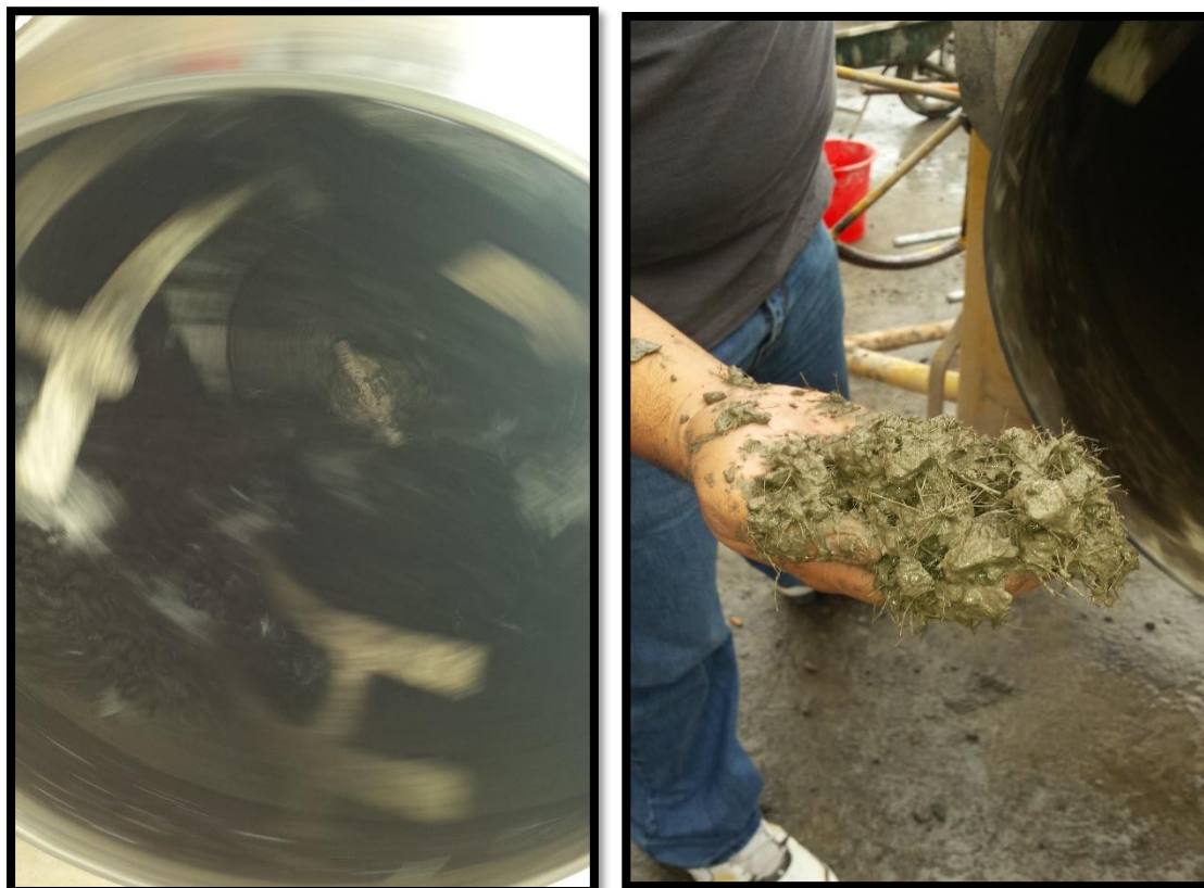
Fotografía 9. Mezcla adicionada fibra de nylon. Fuente: Egda. Johana Núñez
