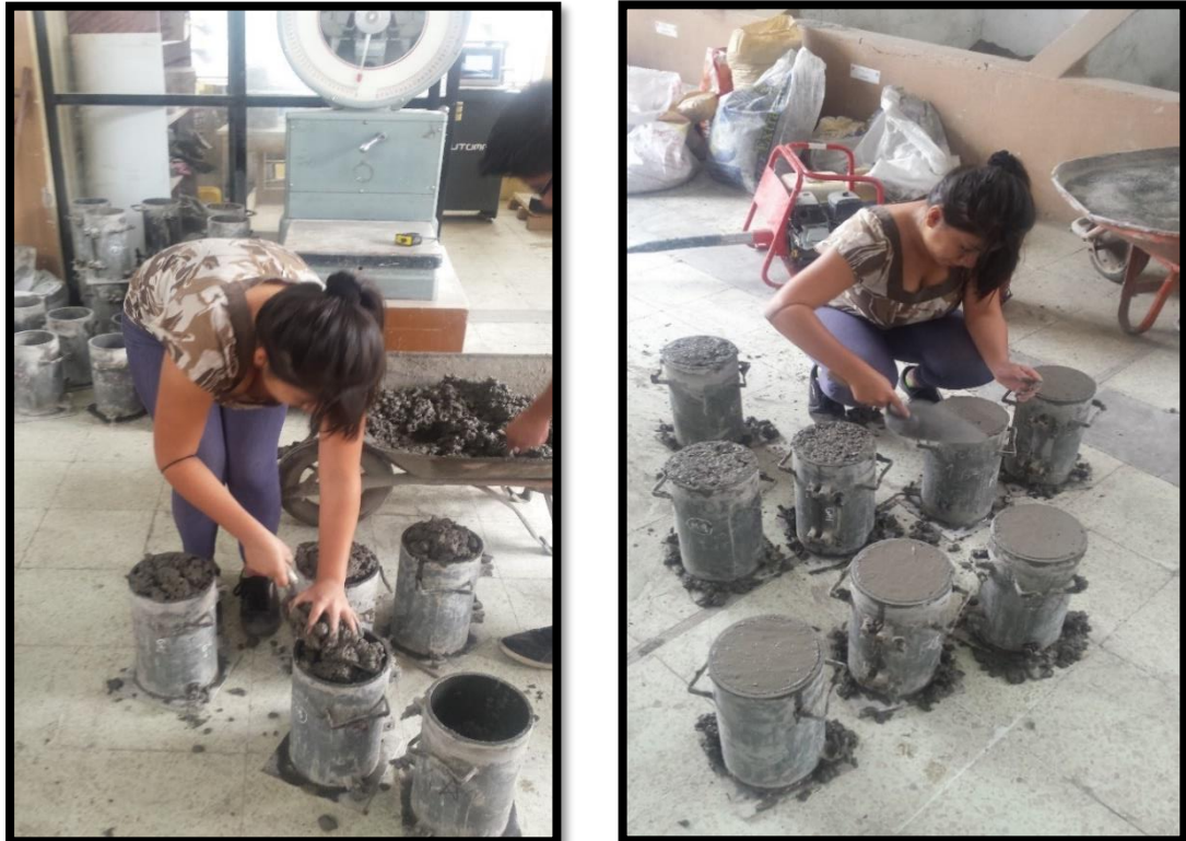
Fotografía 11. Colocación del hormigón por capas y enrasamiento de cilindros. Fuente: Egda. Johana Núñez
