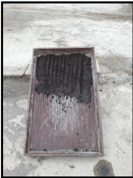
Fotografía 4. Ensayo densidad real del agregado fino. Fuente: Egda. Johana Núñez
