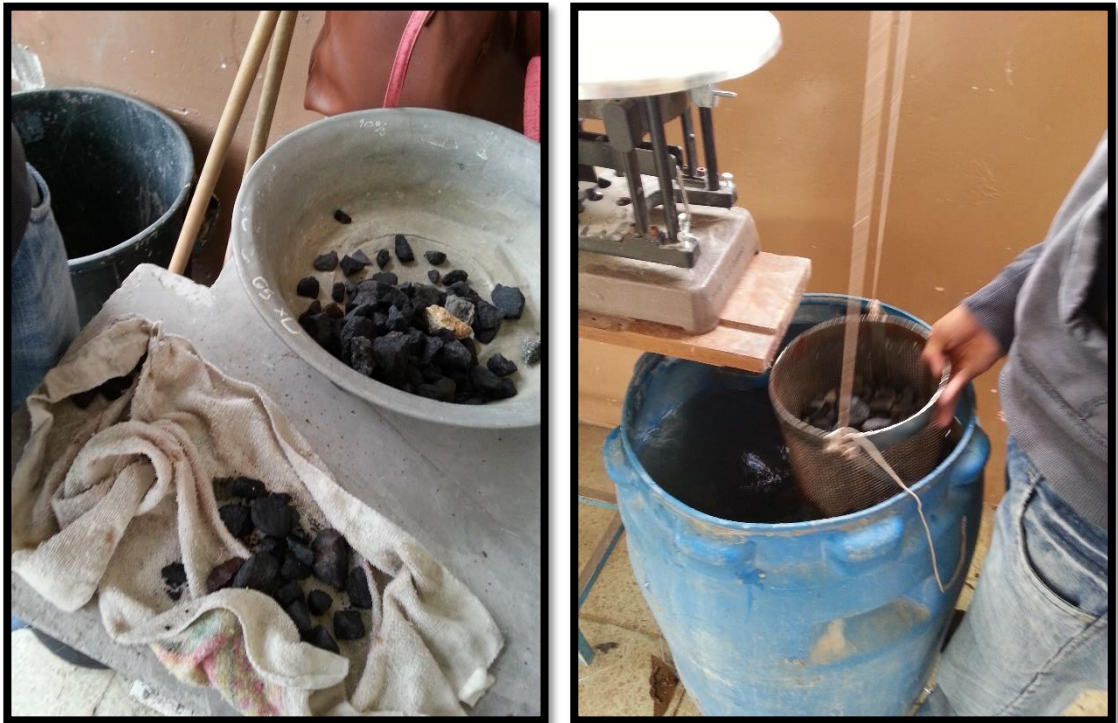
Fotografía 5. Ensayo densidad real del agregado grueso. Fuente: Egda. Johana Núñez
