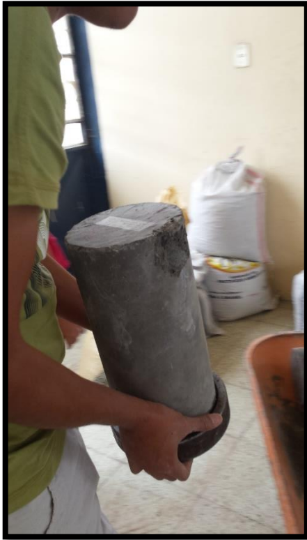
Fotografía 14. Ensayo a compresión de los cilindros de hormigón. Fuente: Egda. Johana Núñez
