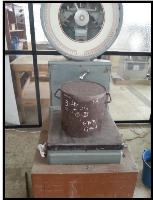
Fotografía 3. Ensayo densidad aparente de los agregados. Fuente: Egda. Johana Núñez
