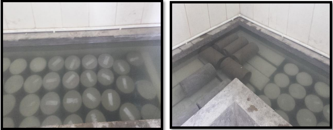
Fotografía 13. Curado de cilindros de hormigón. Fuente: Egda. Johana Núñez
