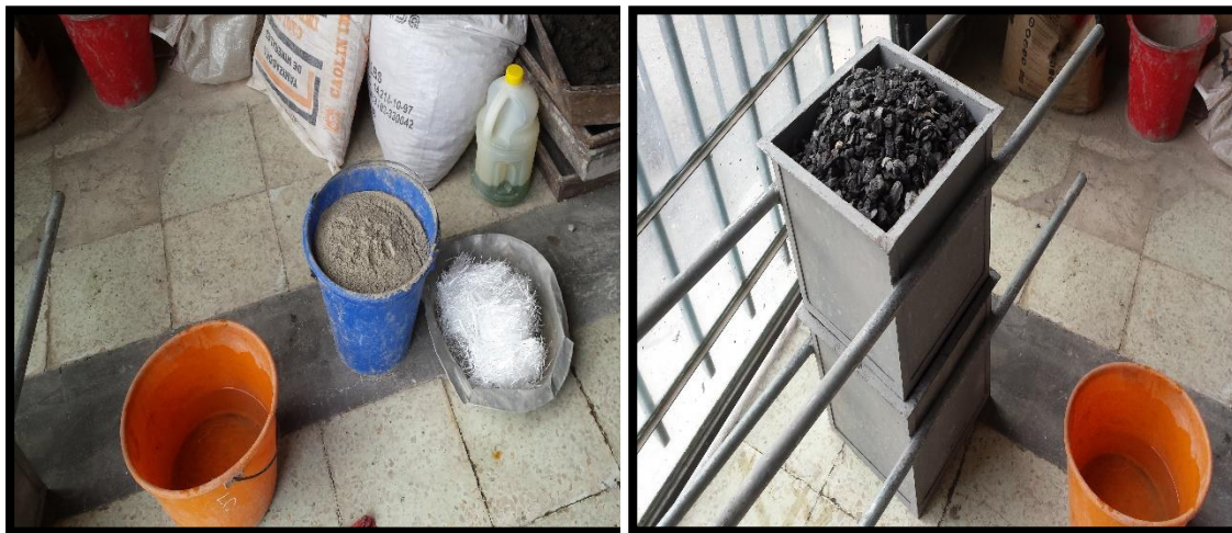
Fotografía 8. Componentes del hormigón dosificados. Fuente: Egda. Johana Núñez
