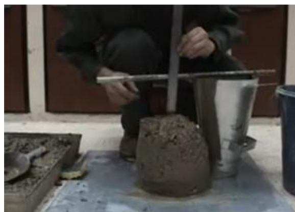
Imagen 4. Medición del asentamiento de la mezcla.
