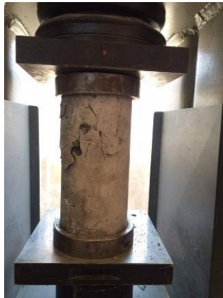
Fotografía N° 23. Rotura y falla del cilindro Fotografía N° 22. Resistencia Obtenida.
