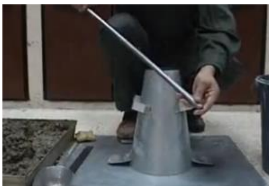
Imagen 3. Colocación del cono de Abrams para la realización del ensayo.
