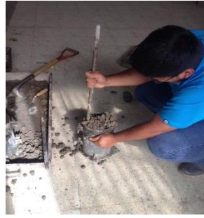
Fotografía N° 15. Compactación del Cilindro.
