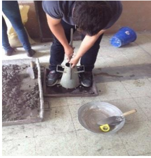
Fotografía N° 14. Ensayo de cono de Abrams.
