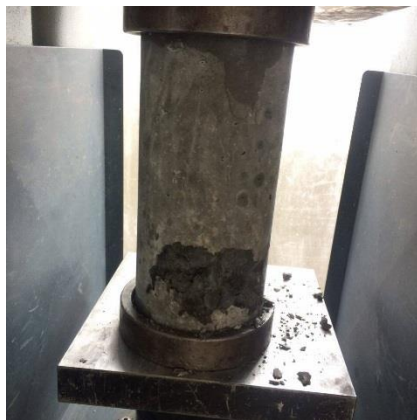
Fotografía N° 24. Resistencia y falla del Cilindro. Fotografía N° 25. Resistencia del Cilindro.
