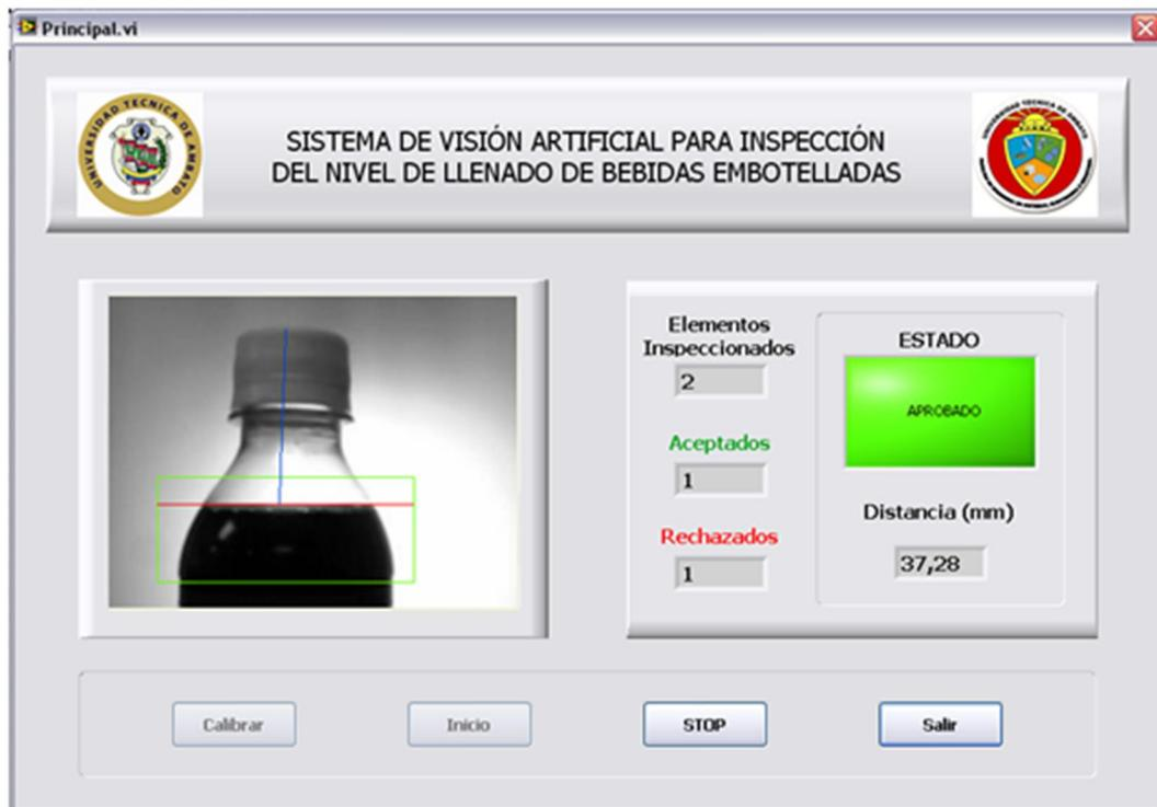
**Figura 6.70** Prueba de control de calidad - botella con nivel de sobrellenado
