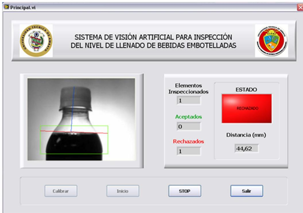
**Figura 6.69** Prueba de control de calidad - botella con nivel de subllenado
