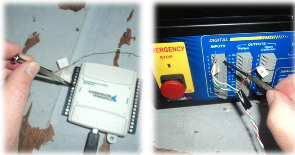
**Figura 6.20** Conexión de la DAQ al módulo de control
