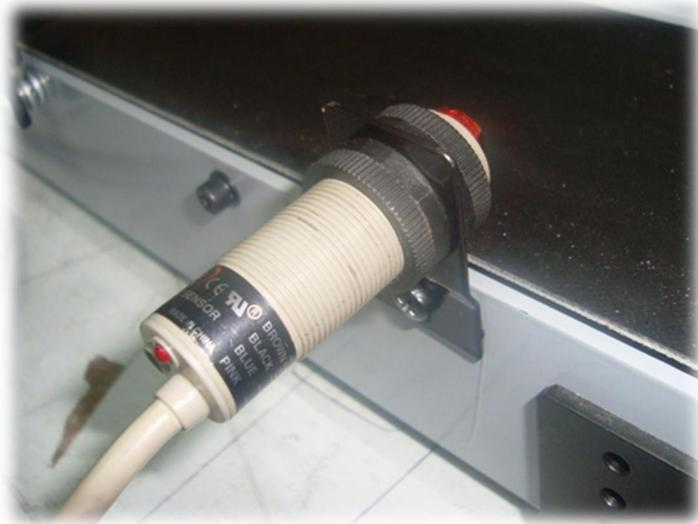
**Figura 6.26** Montaje del sensor de proximidad
