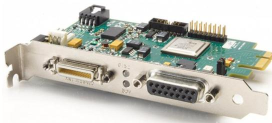
**Figura 2.22** Frame grabber con bus PCI Express compatible con Camera Link
