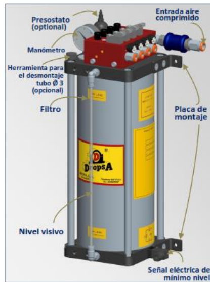
Figura 3. 6 Sistema de mínima cantidad de lubricación MQL.
