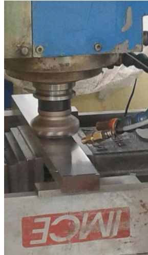
Figura 3. 10 Estabilización de placa de acero.
