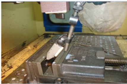
Figura 2. Alineación de la entenalla con reloj palpador.
