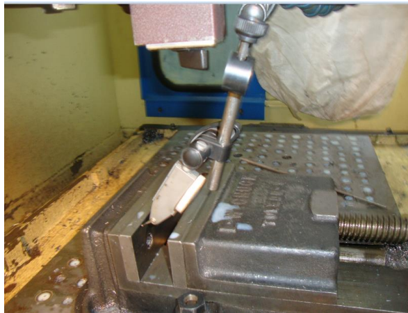
Figura 3. 9 Nivelación de entenalla con reloj palpador.
