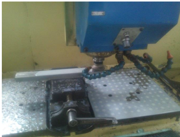
Figura 3. 13 Mecanizado Sistema por inundación.
