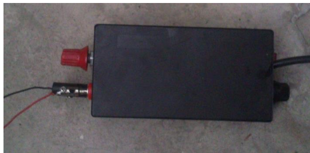
Figura 3. 10.- Fuente de energía de 24v (Autor)
