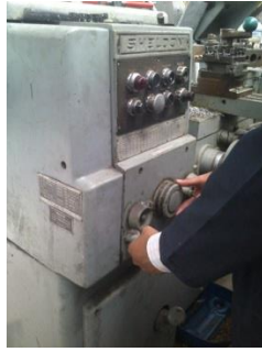
Figura 3. 16.- Ajuste de parámetros de maquinado en el torno(Autor)
