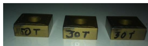
Figura 1.5.- inserto desgastado y observado a simple vista (Autor)
