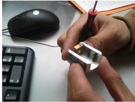
Figura 3. 22.- Colocación de las cuchillas en las mordazas del MEB (Autor)
