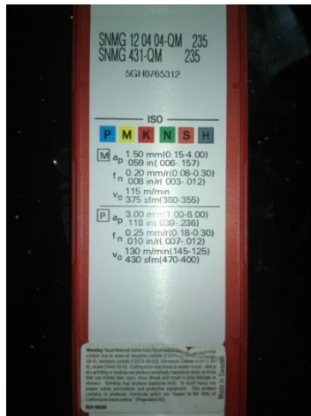
Figura 1.3.- datos técnicos del inserto de metal duro (Autor)
