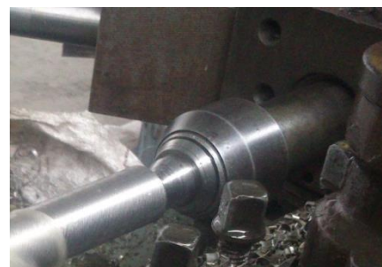
Figura 1.4.- Sujeción del eje en el contrapunto (Autor)
