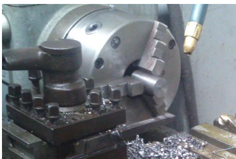
Figura 3. 14.- Refrentado del extremo del eje de acero (Autor)
