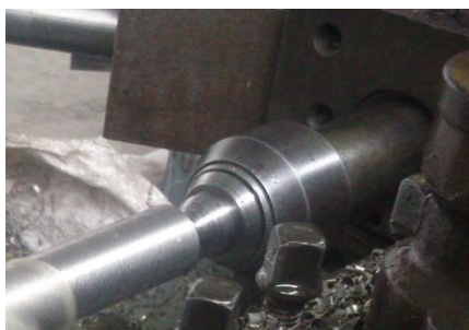
Figura 3. 15.- Sujeción del eje en el contrapunto (Autor)
