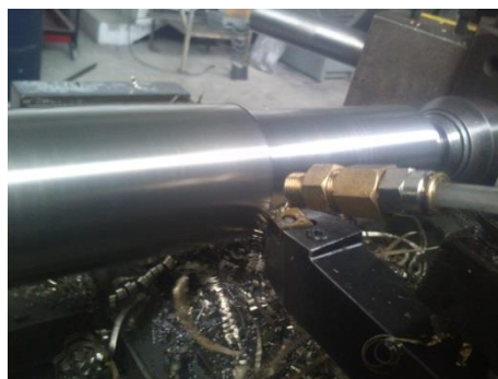
Figura 3. 13.- Equipamiento del sistema de mínima cantidad de lubricación con el torno (Autor)
