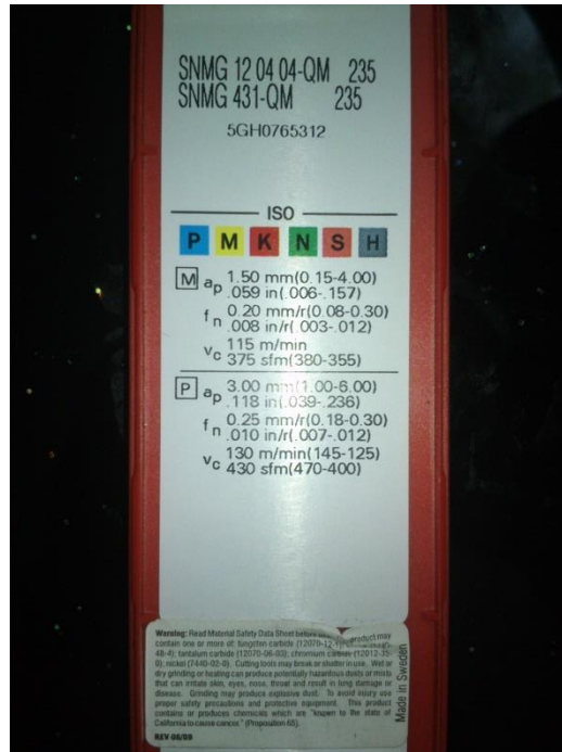
Figura 3. 4.- Datos técnicos del inserto de metal duro (Autor)
