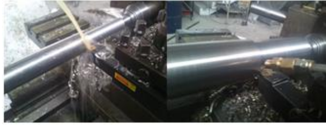
Figura 3. 19.- Mecanizado del acero con taladrina y con sistema MQL (Autor)
