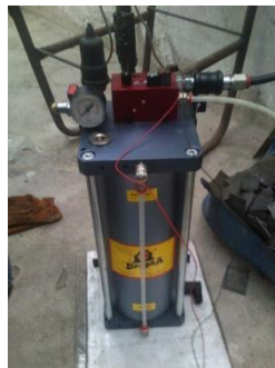
Figura 3. 11.- Sistema MQL conectado y listo (Autor)
