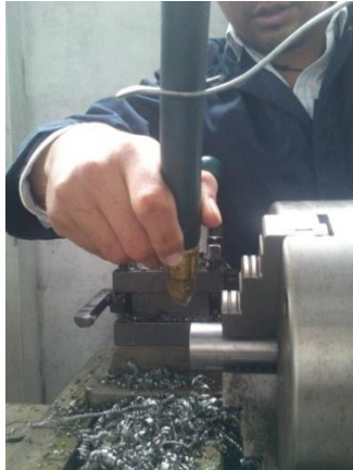
Figura 3. 7.- Sistema de inundación por taladrina del torno (Autor)
