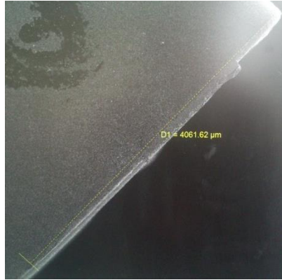
Figura 3. 24.- Medición del flanco principal desgastado(Autor)
