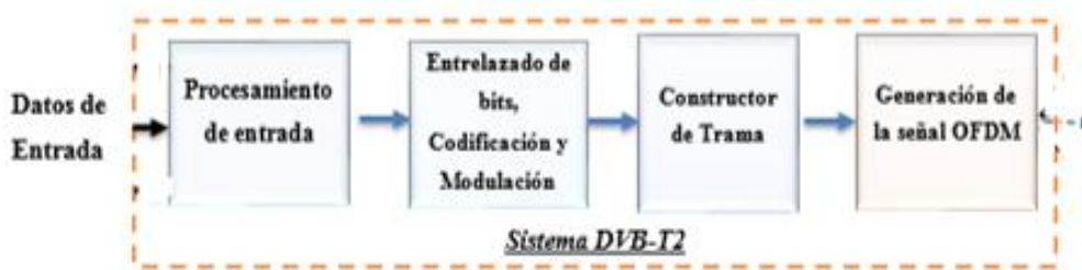
Figura 4. 1: Diagrama de Bloque del sistema DVB-T2 [3]
