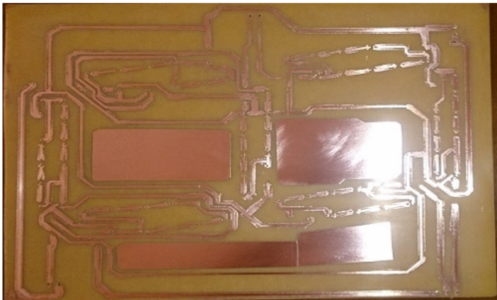
Figura 4.22: Aspecto de las pistas del display después de la oxidación Fuente: El Autor.
