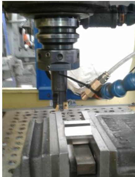
Fig. 3. 17: Aplicación de mínima cantidad de lubricante (Fuente: Autor)
