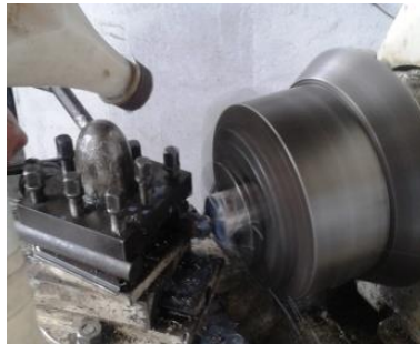
Fig. 3. 4: Refrentado de la pieza (Fuente: Autor)
