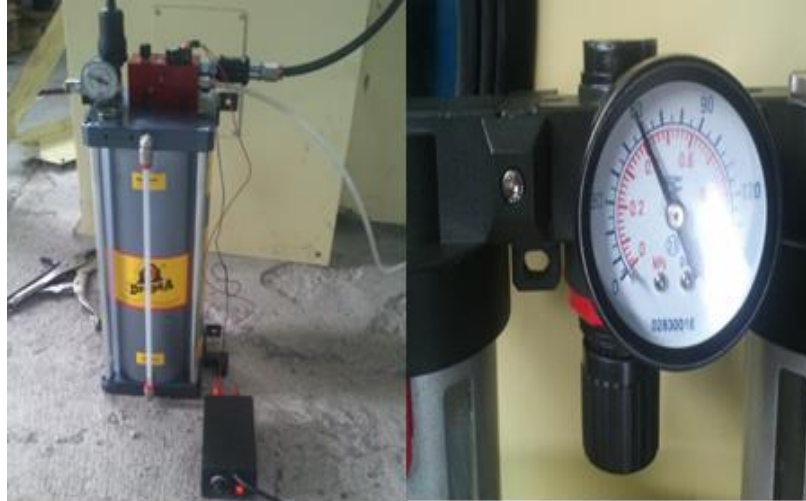
Fig. 3. 16: Sistema de mínima cantidad de lubricante MQL Miquel Pro i (Fuente: Autor)
