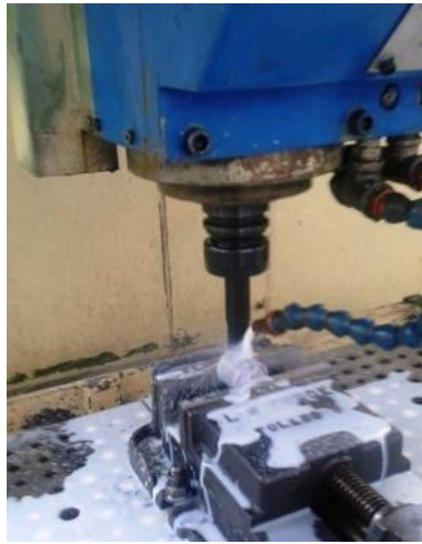
Fig. 3. 6: Ejecución del desbaste (Fuente: Autor)
