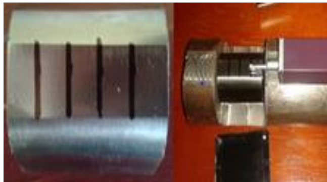
Fig. 3. 21: Áreas de medición de Ra en la probeta mecanizada (Fuente: Autor)
