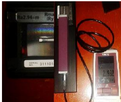
Fig. 3. 20: comparación de rugosidad superficial Ra (2.94um) (Fuente: Autor)
