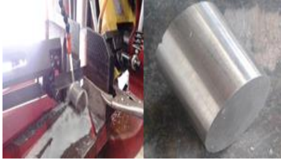
Fig. 3. 3: Corte del acero inoxidable AISI 304 (Fuente: Autor)
