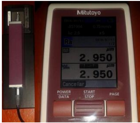
Fig. 2: Calibración del rugosímetro con el patrón de rugosidad (Fuente: Autor)
