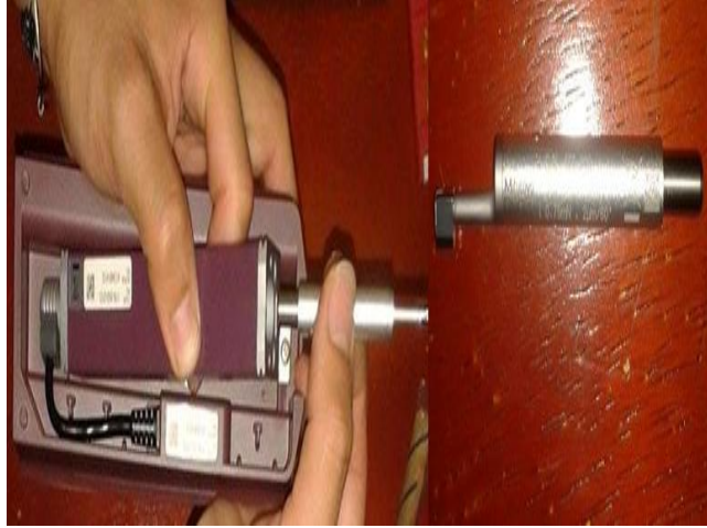
Fig. 3. 18: Ingreso del palpador en el Rugosímetro Mitutoyo SJ 210 (Fuente: Autor)
