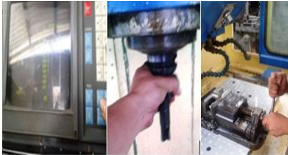
Fig. 3. 14: Preparación de herramienta en el centro de mecanizado (Fuente: Autor)
