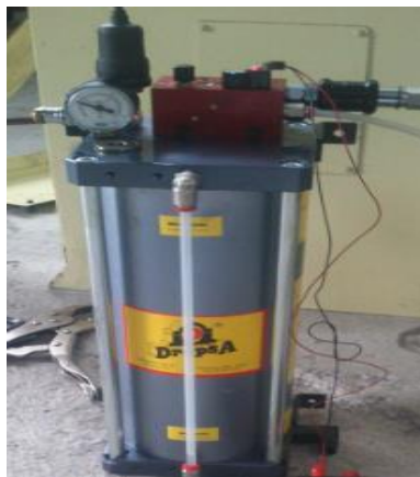
Fig. 3. 11: Nivel de aceite del sistema MQL (Fuente: Autor)
