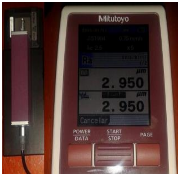
Fig. 3. 19: Calibración del rugosímetro con el patrón de rugosidad (Fuente: Autor)
