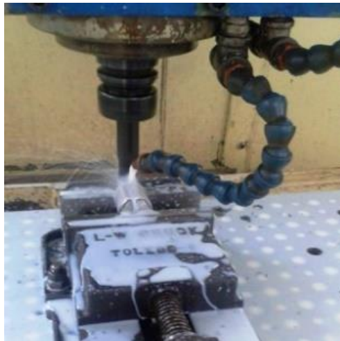
Fig. 3. 15: Ejecución del mecanizado bajo condiciones de inundación (Fuente: Autor)
