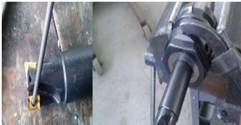
Fig. 3. 13: Herramienta de corte de la marca Sandvik Coromant (Fuente: Autor)
