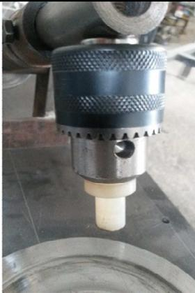
**Figura N° 6 7.** Pin insertado en el mandril.
