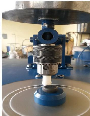
*Figura Nº 6 13. Mandril del sistema Pin on Disk*
