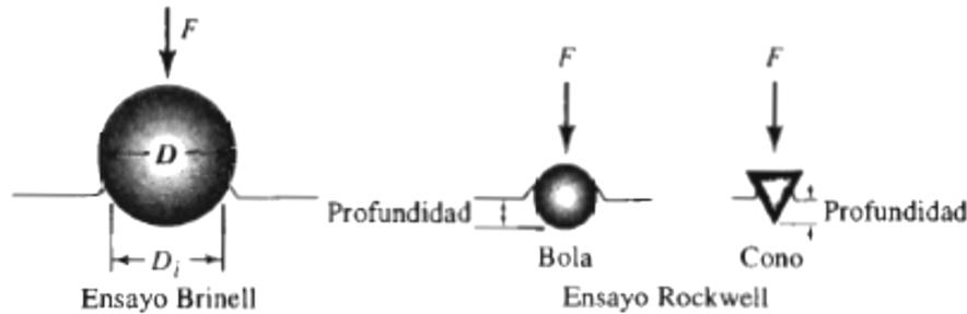
**Figura Nº 2 21.** Ensayos de dureza Brinell y Rockwell
