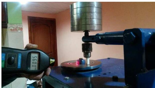
**Figura N° 6 9.** Medición de rpm del motor con el tacómetro.
