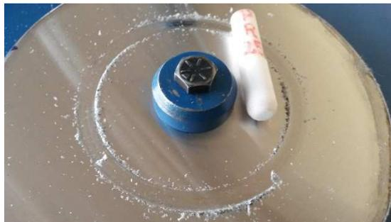
**Figura Nº 6 11.** Material desgastado y adherido del pin en el disco.
