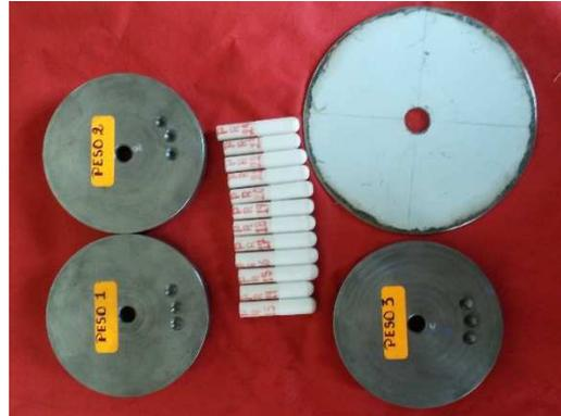
Figura № 4 42. Disco-Carga 2-y Pines para desgaste adhesivo
