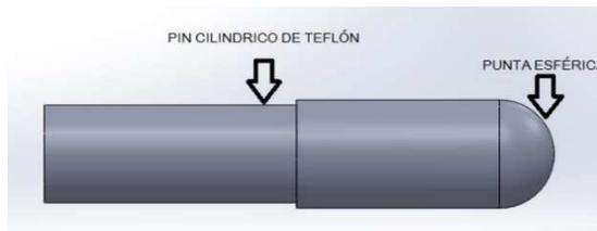
Figura Nº 6 2. Forma del pin de teflón
