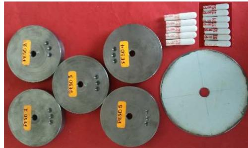
Figura № 4 43. Disco-Carga 3-y Pines para desgaste adhesivo
