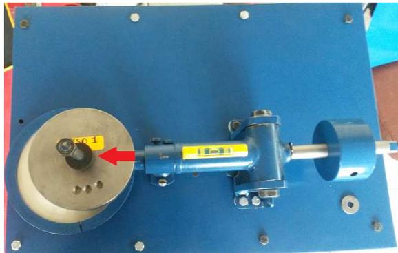
**Figura N° 6 8.** Masa con seguro de caucho.
