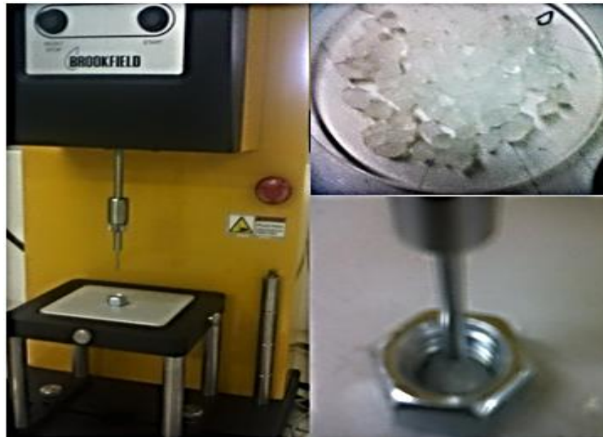
Figura 4. Equipo utilizado y adaptaciones realizadas para determinar el perfil de textura del Aloe vera antes y después del tratamiento térmico.
