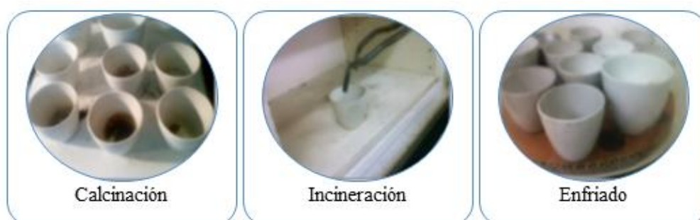
Figura 8: Proceso utilizado en la determinación del contenido de cenizas en las muestras de yogur.
