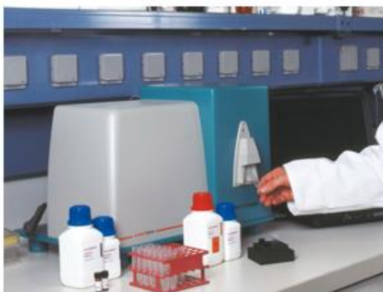
Figura 11. Equipo de fotoquimioluminiscencia utilizado para el análisis de actividad antioxidante de las muestras de yogur.
