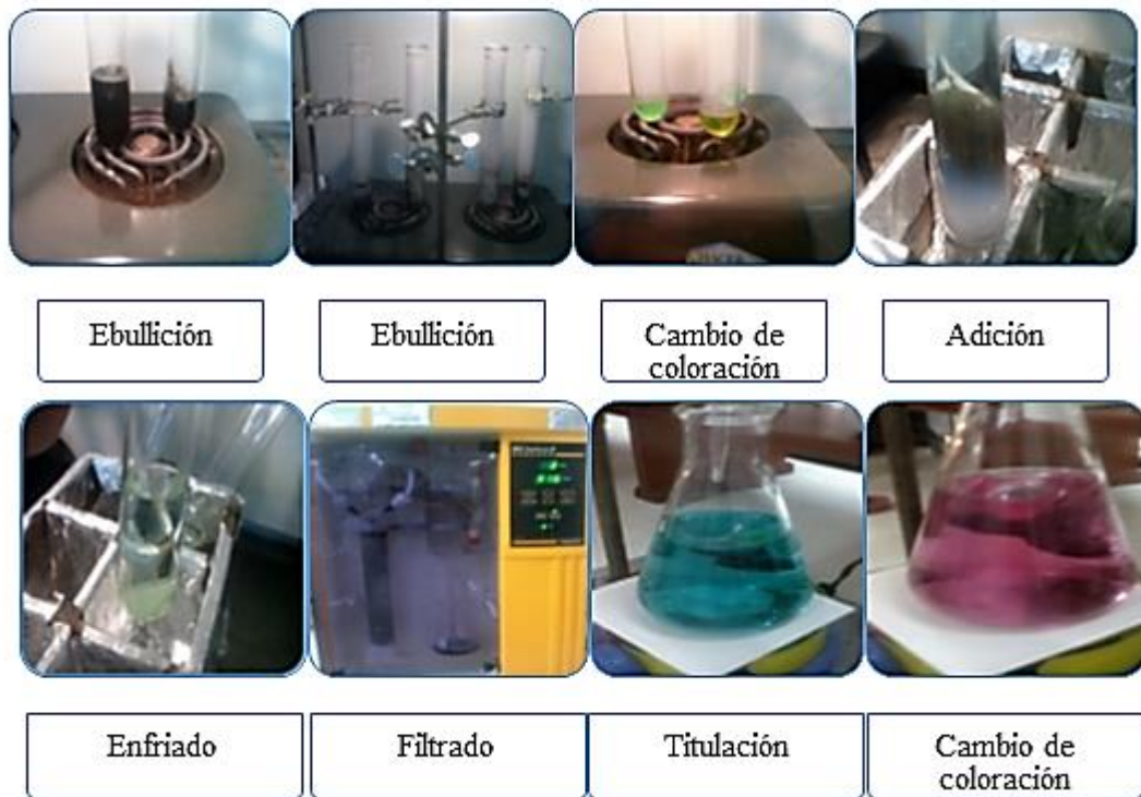
Figura 6: Proceso seguido en la determinación del contenido de proteína en las muestras de yogur.
