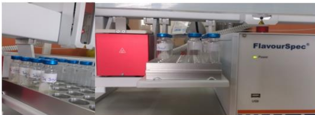
Figura 13. Ensayo de las muestras de yogur en nariz electrónica.
