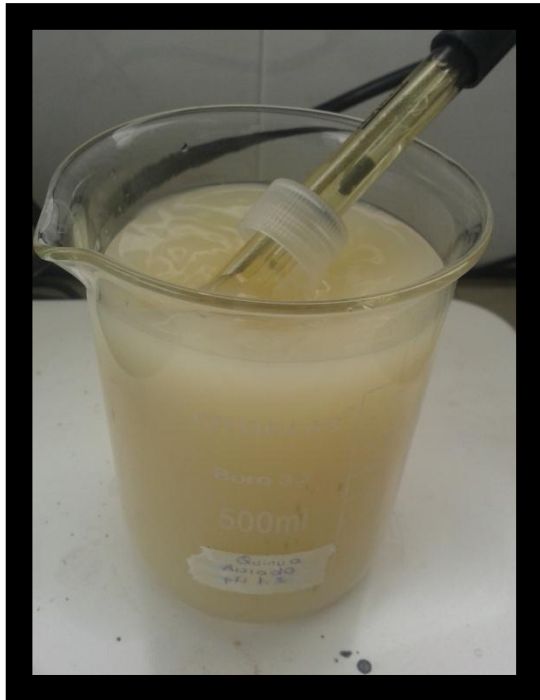
Figura 29. Precipitación isoelectrica de la proteína a pH 4,0 (sobrenadante)
