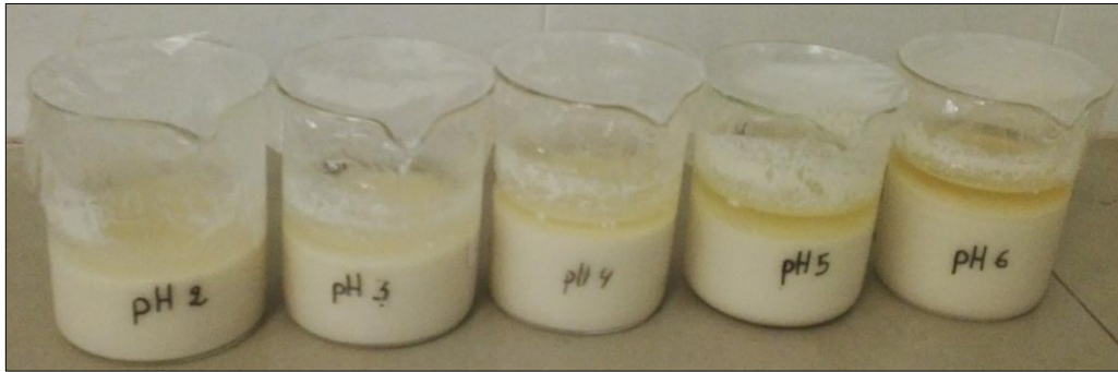
Figura 3. Precipitados de aislados de proteína de quinua a diferentes valores de pH (2,0; 3,0; 4,0; 5,0 y 6,0).
