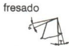
Figura 2-14 Ángulos para fresado
