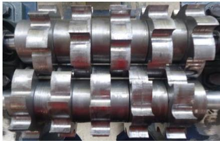
Figura 6-2: Disposición de cuchillas y separadores
