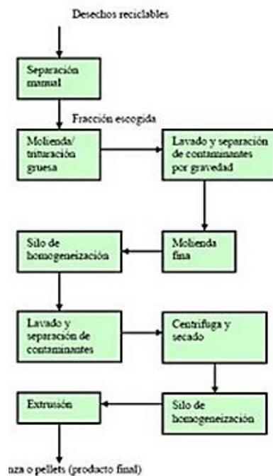
Figura 2-22. Proceso de reciclado mecánico
