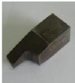
*Figura 2-17: Martillo o punzón para ensayo*
