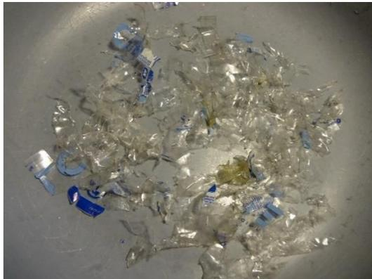
*Para una botella mediana se obtiene un rango de granulometría de (6-12) mm.*
