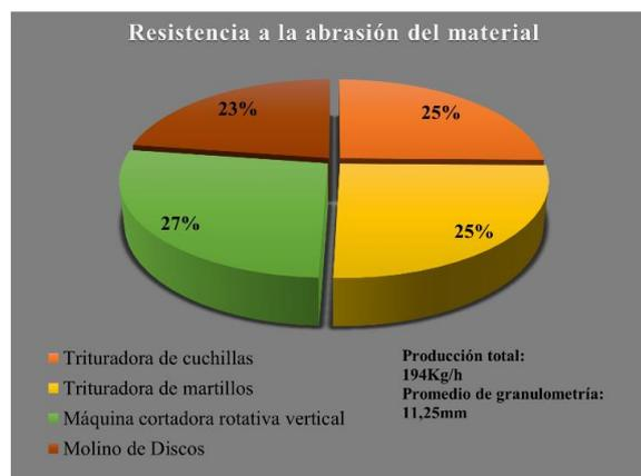
Figura 4-7 Porcentajes de producción de acuerdo al cambio de la dureza del material.
