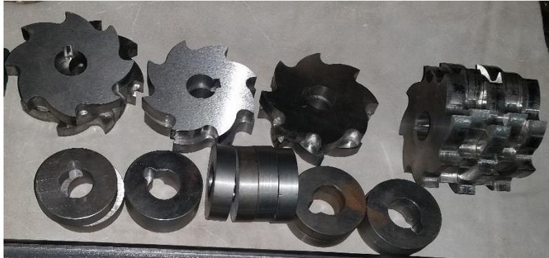
*Figura 6-63: Discos de trituración y separadores*
