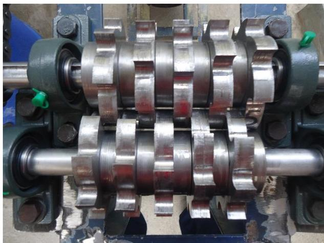
*Figura 6-65: Cuchillas y separadores sobre eje.*
