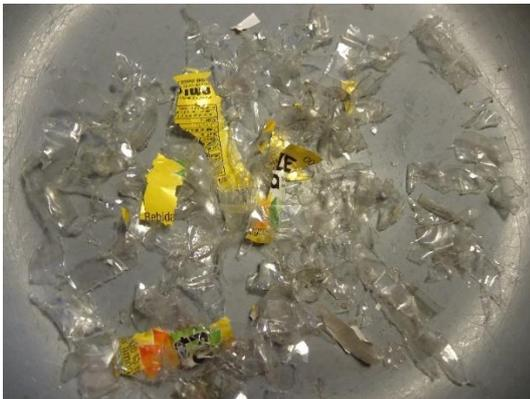
*Para una botella grande se obtiene un rango de granulometría de (8-12) mm.*
