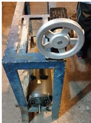
*Figura 6-62: Montura de motor y reductor*
