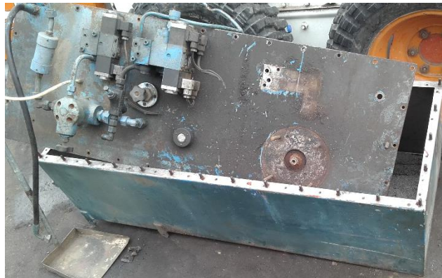
Figura 6-12 Tanque hidráulico y sus componentes medidas 100x50x50 Autor: Darwin Chiluisa
