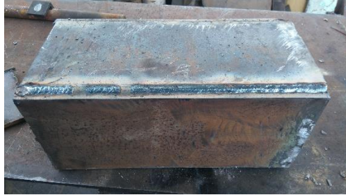
Figura 6-15 Suelda del conjunto del molde Autor: Darwin Chiluisa
