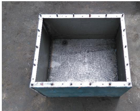
Figura 6-16 Tanque Hidráulico Autor: Darwin Chiluisa
