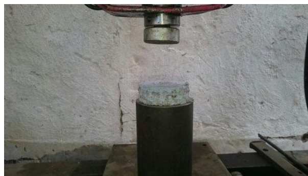
Figura 4-7 Retiro de la probeta compactada Autor: Darwin Chiluisa
