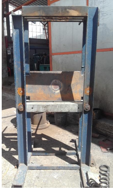
Figura 6-11 Estructura de cuatro columnas UPN Autor: Darwin Chiluisa
