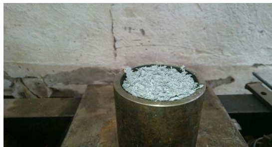
Figura 4-4 Limpieza y colocación del raspado de cuero en el molde Autor: Darwin Chiluisa
