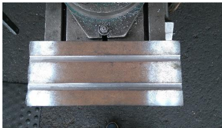
Figura 6-13 Cepillado de guías para el molde Autor: Darwin Chiluisa
