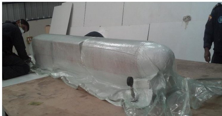
Figura 6-1 Proceso de laminado al vacío en el CIDFAE. Fuente: (Autor)
