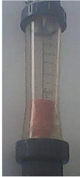
**Figura 6-8 Medidor de caudal (Rotámetro).**
