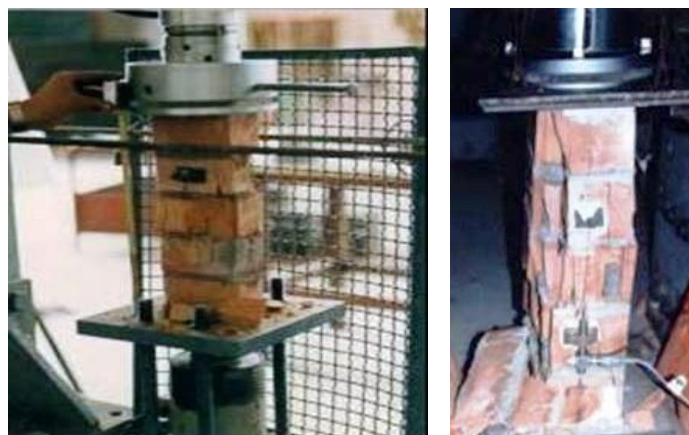
Figura 4.12 Ensayo de Compresión en un prisma de bloques
