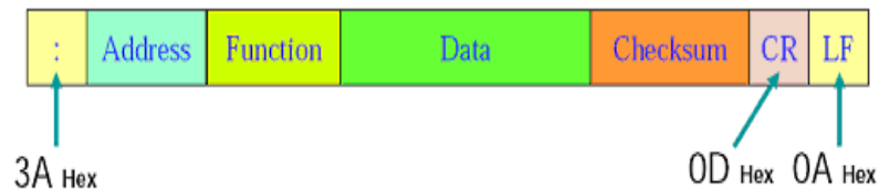
Fig. 23.- Estructura de las Tramas Modbus ASCII
