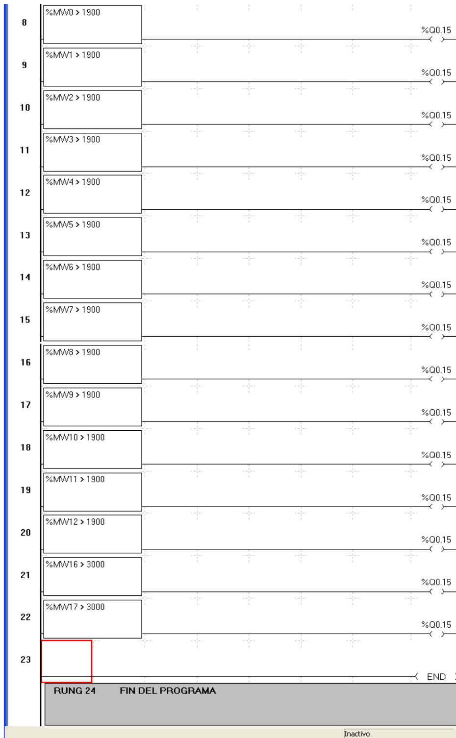
Fig. 72.- Sección 4 LADDER. Control y comparación.
