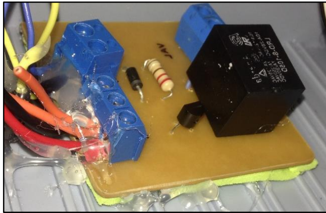
Figura B11 Placa de potencia que activa la electroválvula.
