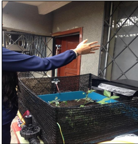
Figura 4.46 Pruebas del sensor ultrasónico para aves desde una distancia media
