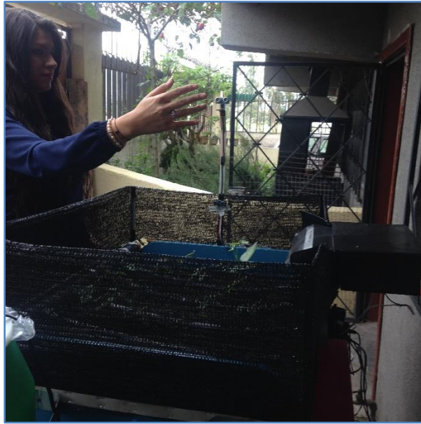
Figura 4.47 Pruebas del sensor ultrasónico para aves desde una distancia larga
