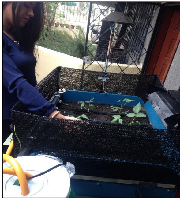
Figura 4.50 Pruebas del sensor ultrasónico para roedores desde una distancia larga
