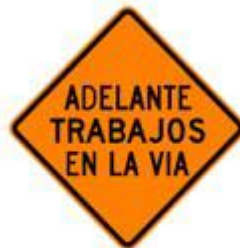
Gráfico 63 Adelante trabajos en la vía (T1-4)
