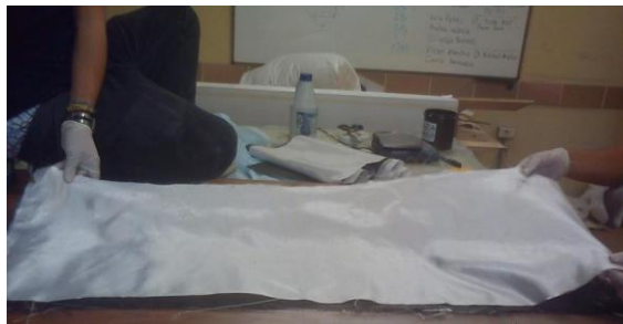
Figura 2.7.- Aplicación de las capas de fibra y resina en el laminado (GUTIERREZ, GARCIA, RODRIGUEZ, & AYALA, 2011)
