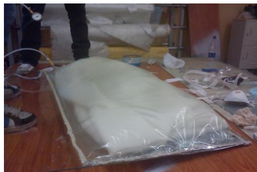
Figura 2.8.- Montaje para generar vacío en el proceso de curado del laminado (GUTIERREZ, GARCIA, RODRIGUEZ, & AYALA, 2011)
