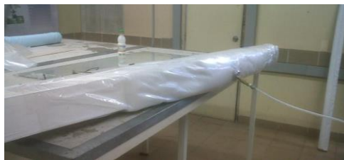
Figura 2.11.- Montaje de la viga aplicando vacío (GUTIERREZ, GARCIA, RODRIGUEZ, & AYALA, 2011)
