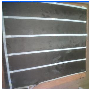
Figura 2.10.- Fibra de carbono para el proceso de construcción de la viga principal del ala, (GUTIERREZ, GARCIA, RODRIGUEZ, & AYALA, 2011)
