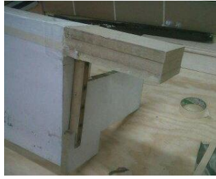
Figura 2.9.- Alargamiento del molde para alargamiento de la viga (GUTIERREZ, GARCIA, RODRIGUEZ, & AYALA, 2011)
