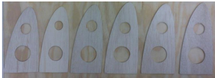
Figura 2.5.- Costillas del borde de ataque del ala central. (GUTIERREZ, GARCIA, RODRIGUEZ, & AYALA, 2011)
