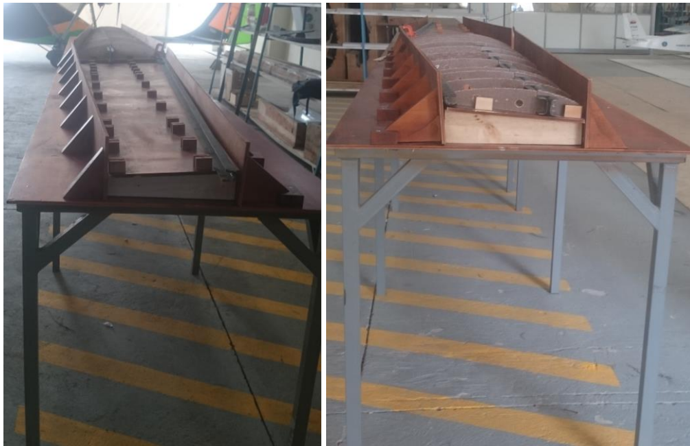
Figura 6.14.- Construcción terminada del jig, Fuente: autor
