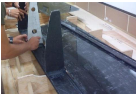
Figura 2.15.- Aplicación de pegamento para pegar la viga principal con la piel del intradós del ala central (GUTIERREZ, GARCIA, RODRIGUEZ, & AYALA, 2011).
