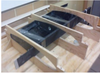
Figura 2.16.- Ensamblaje y pegado de la viga secundaria (GUTIERREZ, GARCIA, RODRIGUEZ, & AYALA, 2011)
