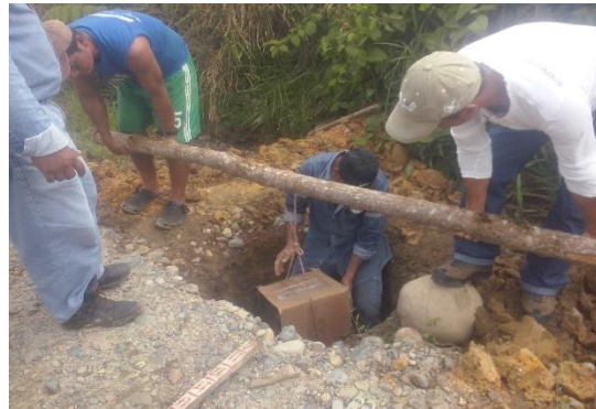
Extracción de la muestra inalterada – Km 4 + 000
