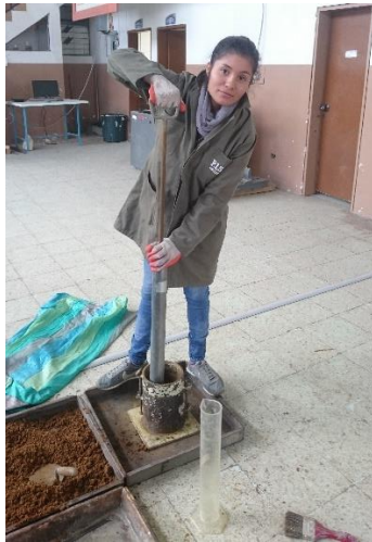
Ensayo de compactación (CBR) por c/km: Proctor Modificado - 3 moldes.
