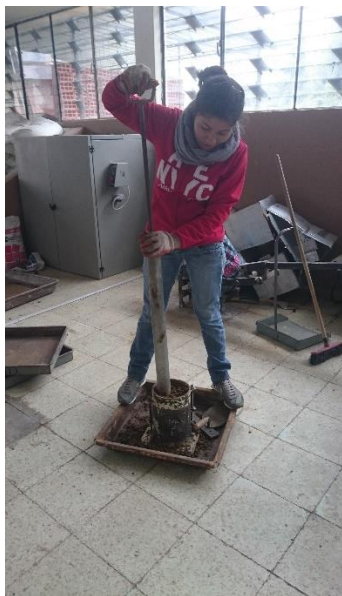
Ensayo de compactación(4 moldes) por c/km: Proctor Modificado - B
