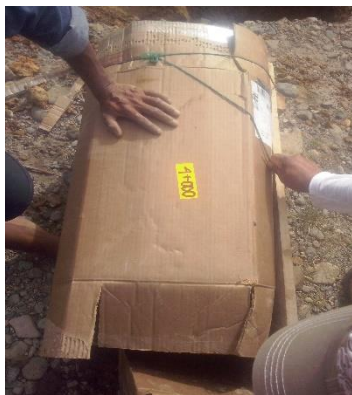
Empacado de la muestra inalterada – Km 4 + 000
