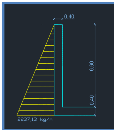
Gráfico 38. Esquematación del esfuerzo del suelo sobre la pared del tanque
