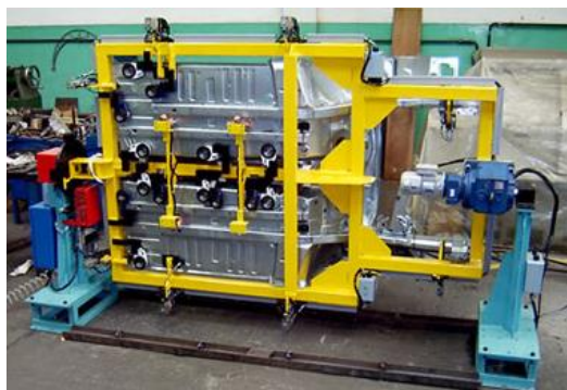
Figura 2. Dispositivo móvil para chapistería y pernos de auto Focus
