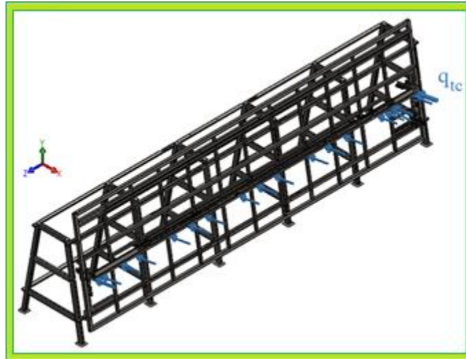
Figura 14. Esquema de posición de carga en el perfil porta faldón
