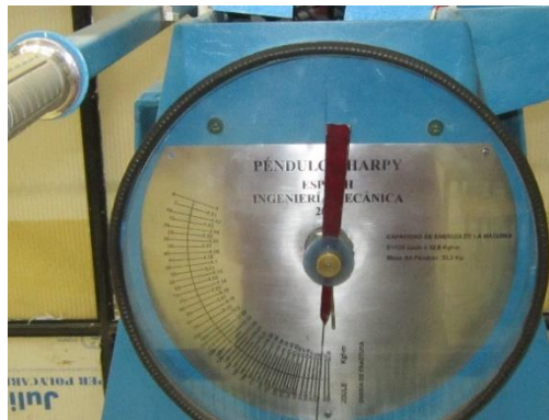
Figura 4.8 : Péndulo Charpy (Fuente: El Autor)
