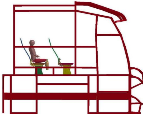
Figura 4.26: Colocación de los dummies en el asiento auxiliar (Fuente el autor)
