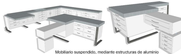
Mobiliario suspendido, mediante estructuras de aluminio permitiendo estas proporcionar una facil limpieza.
