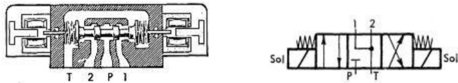
Figura.- 9 Válvulas de cuatro vías operadas eléctricamente.
