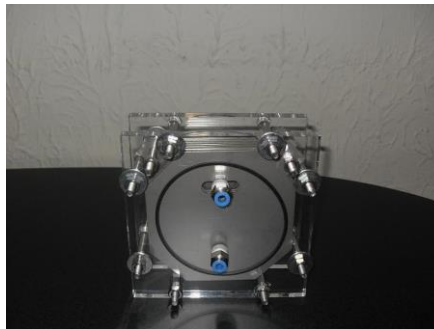
Fig. 4 Celda seca de hidrógeno [14]
