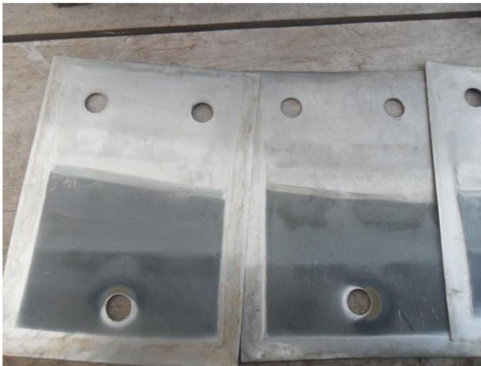
Fig.55 Electrodo después de la electrolisis
