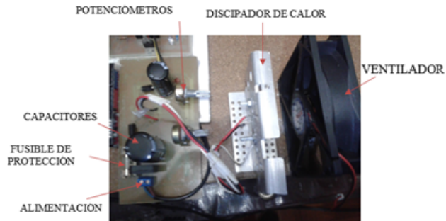
Figura 87: Fuente regulable de 24 VDC. Elaborado por: El Investigador.
