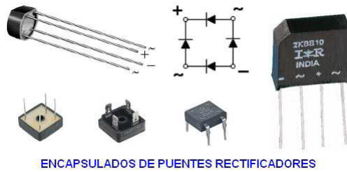
Figura 85: Tipos de encapsulamiento del rectificador tipo puente. Fuente: http://www.mcbtec.com/fuentes_lineales.html
