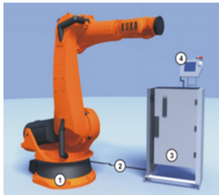
Figura 6: Arquitectura básica de un Sistema Robótico .
