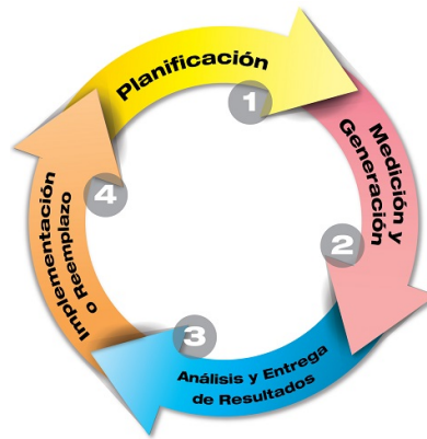
Figura 4.3: Fases generales de las pruebas Benchmarking Fuente: Oscar Vallejo, Evaluación del rendimiento de un sistema informático
