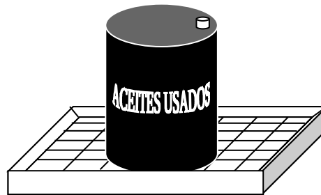
Figura 6.1. Disposición del tanque contenedor.
