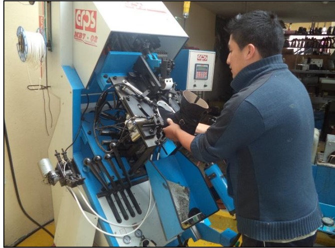
Fig. 12. Montaje de las puntas, los lados y el talón al corte
