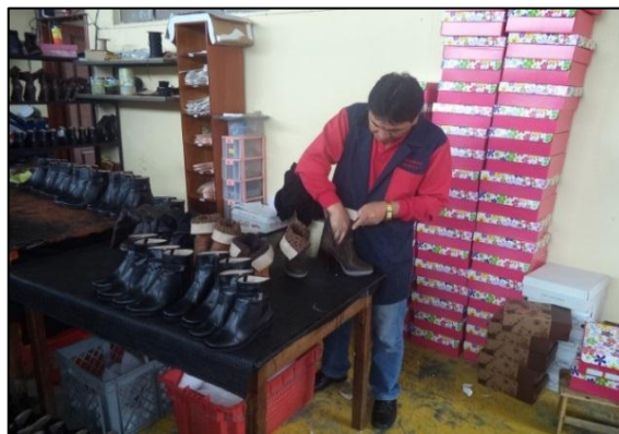
Fig. 16. Colocación de las plantillas en las botas
