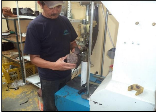
Fig. 15. Fijación del tacón a la bota en la máquina clavadora de tacos
