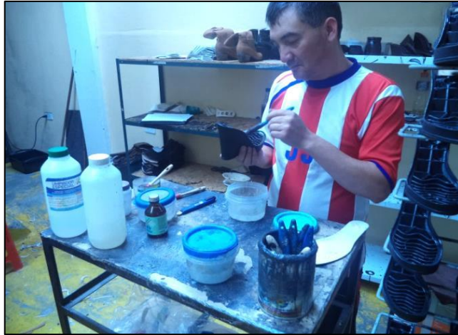
Fig. 13. Aplicación del líquido activador a las suelas
