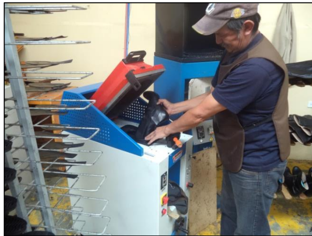
Fig. 14. Fijación de la unión del corte y la suela en la máquina prensadora boca de sapo
