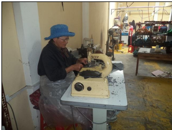
Fig. 9. Operación de desbastado de las piezas de cuero
