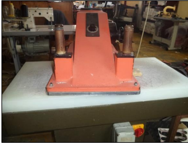
Fig. 7. Troqueladora para el cortado inicial del cuero
