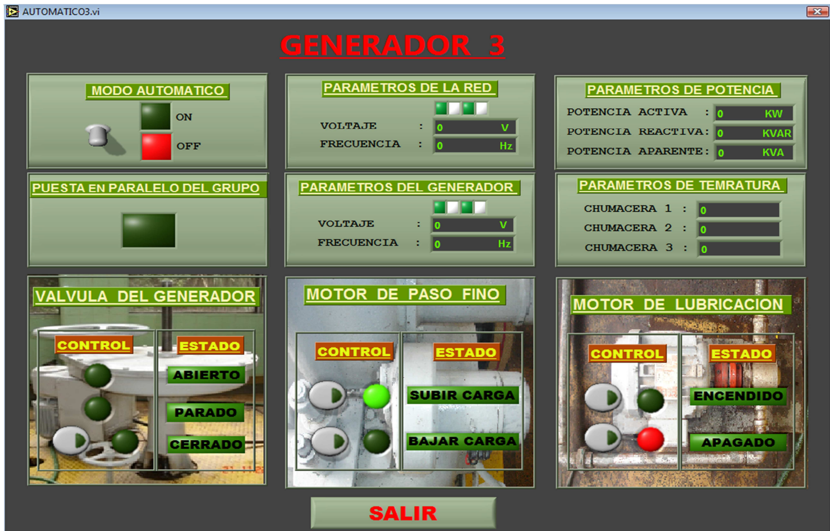
Fig 60. Panel frontal. Modo de operación Automático Grupo Generador #3.
