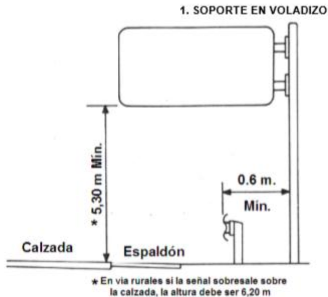
FIGURAS 8.3 Estructuras típicas para señales elevadas (Todas las dimensiones en metros)
