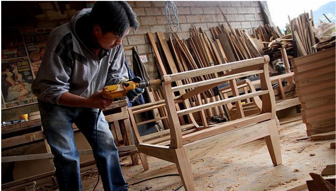
Gráfico 35: Ensamblaje de muebles
