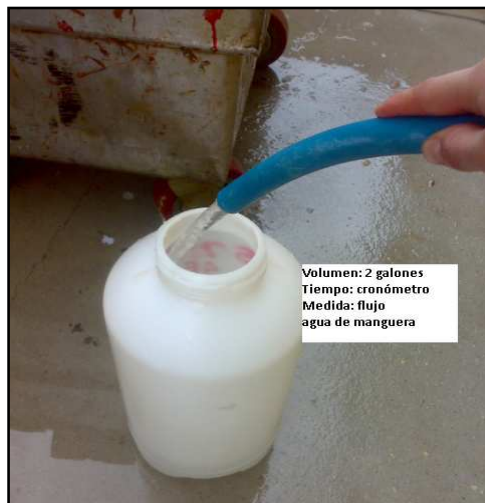
FOTO 2.2 Medida experimental de caudal, se emplea un recipiente con medida (2 gol.) y un cronómetro (tiempo)
