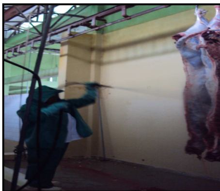
FOTO 2.14 Lavado de la canal con agua a presión
