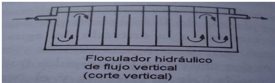
Gráfico No. 24. Floculador hidráulico
