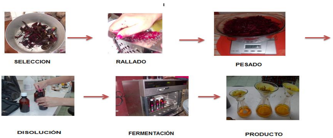
Diagrama # 3. Obtención del Colorante por Fermentación.
