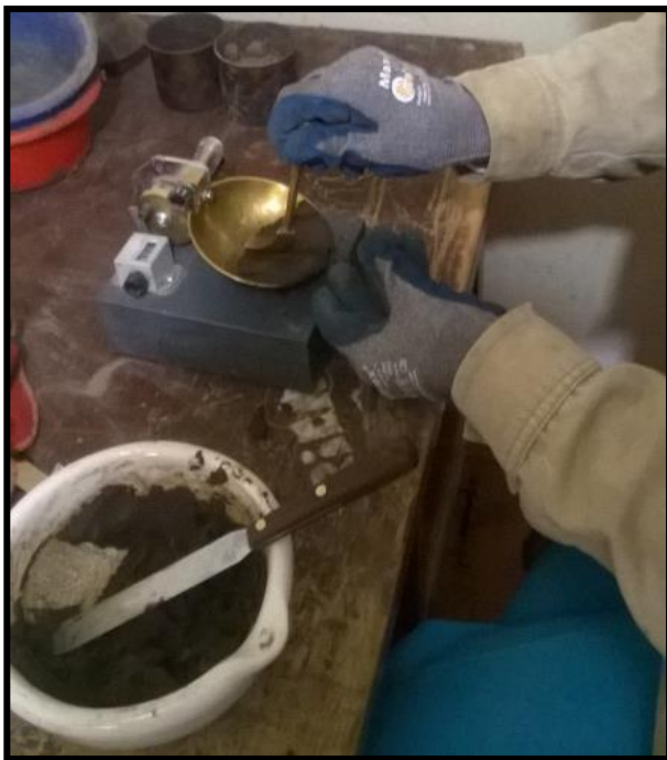
N°7: Determinación de límite líquido
