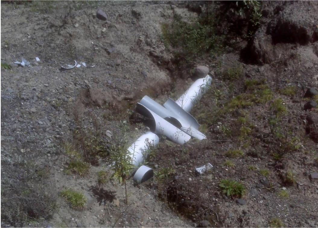
**LÍNEA DE CONDUCCIÓN Y RESIDUOS DE DAÑOS ANTERIORES EN UNA RED DE CONDUCCIÓN DE AGUA**
