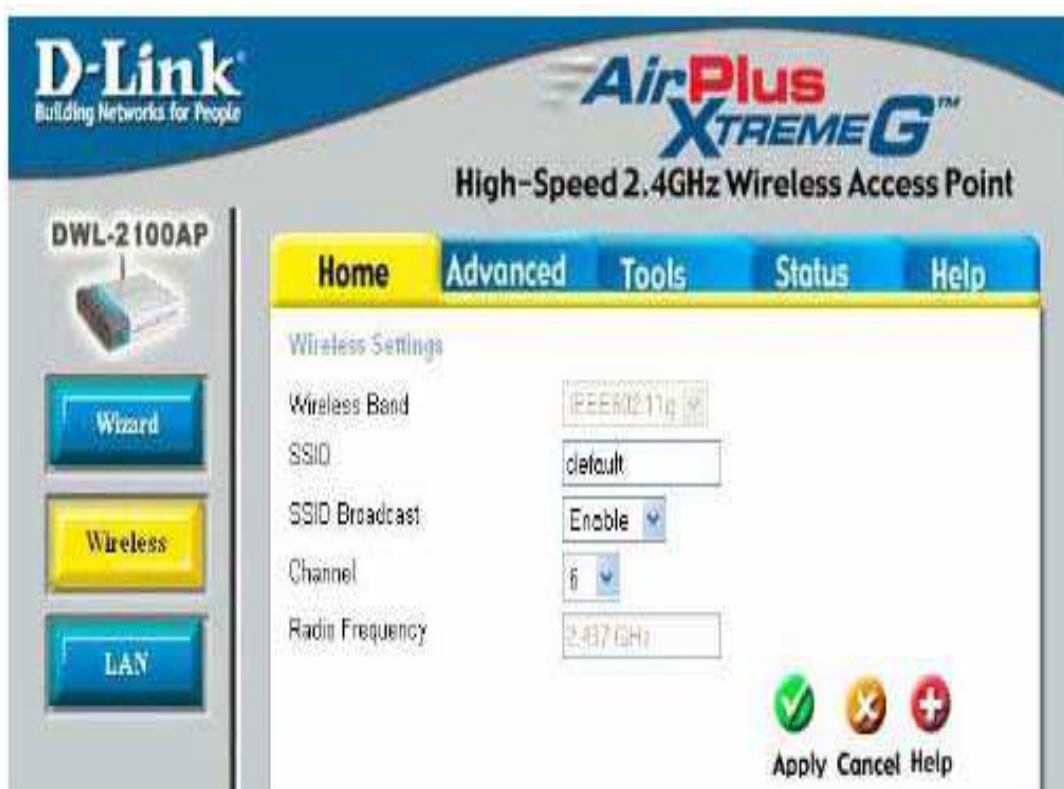
Figura 6.6: Configuración del SSID
