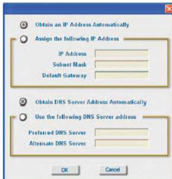
Figura 6.12. Configuración de las propiedades IP de la Tarjeta de Red
