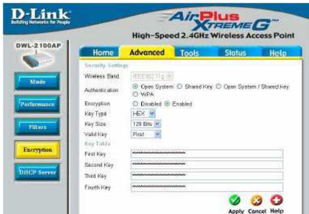
Figura 6.8: Configuración de la encriptación del Access Point
