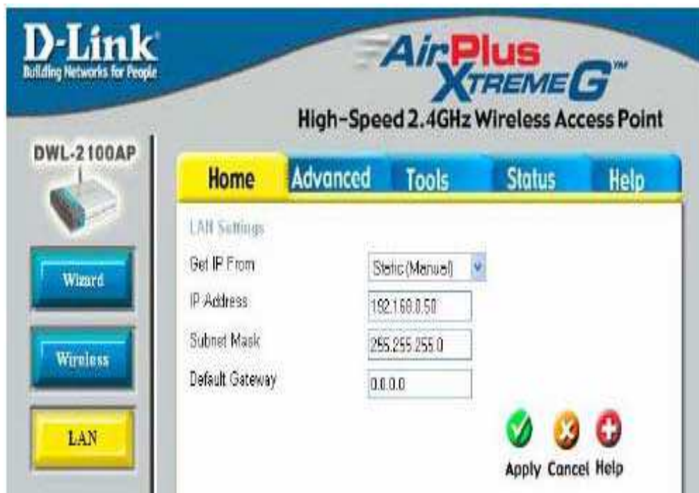
Figura 6.7: Configuración de la IP del Access Point
