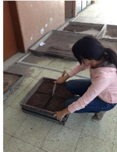
Cuarqueo de la muestra para la determinación de la granulometría
