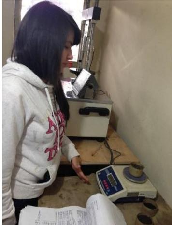
Peso de la muestra para determinar el contenido de humedad
