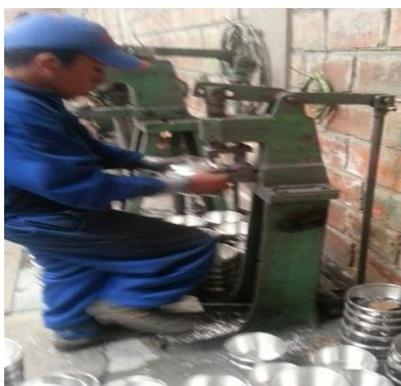
**Fig. N° 44:** Perforado de la olla
