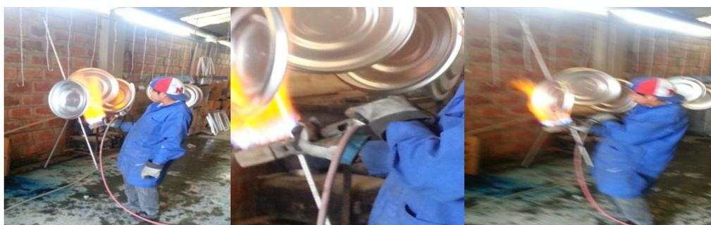
**Fig. N° 74:** Secado de las tapas
