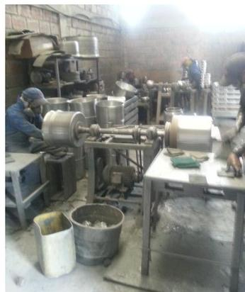
**Fig. N° 37:** Colocación olla en el torno de pulido
