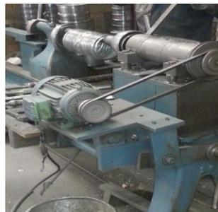
**Fig. N° 32:** Estabilización y Centrado de la forma de olla
