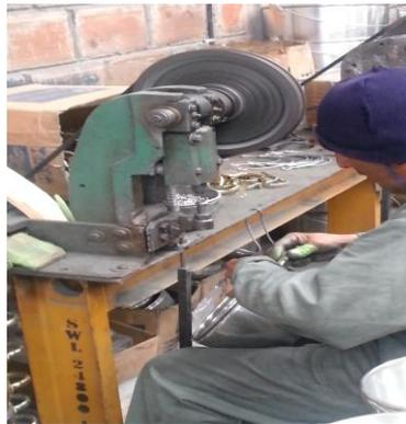
**Fig. N° 49:** Colocación Asas
