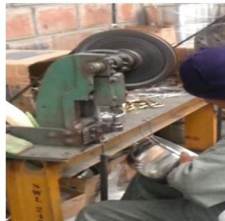
**Fig. N° 47:** Encendido de la remachadora
