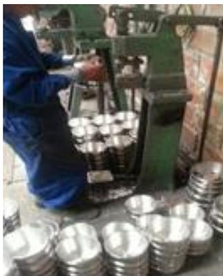
**Fig. N° 43:** Ubicación de la olla en la perforadora
