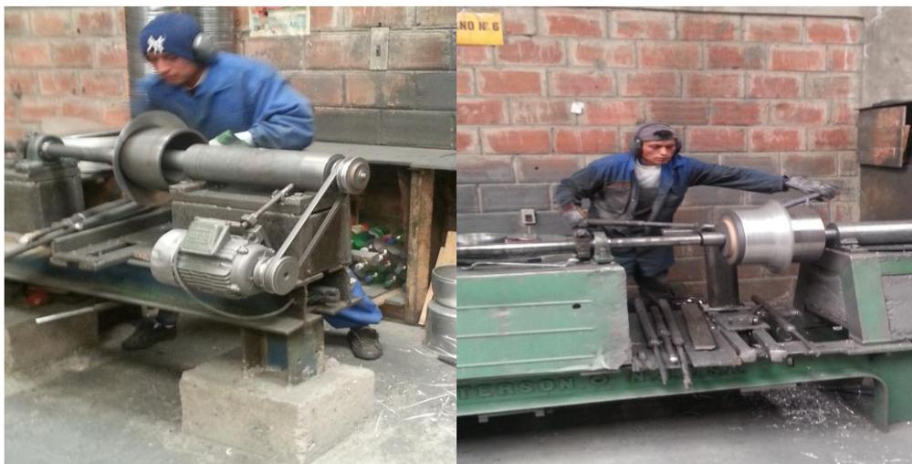
**Fig. N° 8:** Proceso de Repujado
