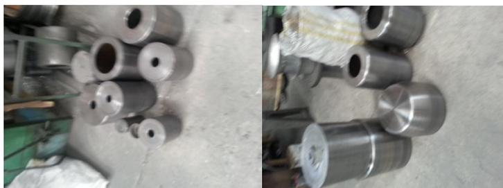
**Fig. N° 26:** Moldes para el repujado
