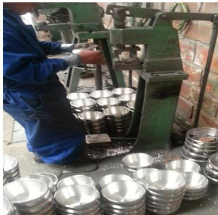
**Fig. N° 10:** Proceso de Perforado
