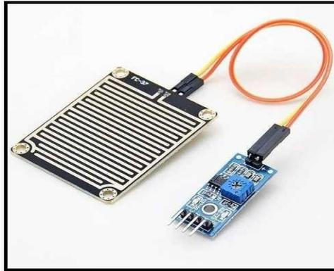
**Fig.41:** Sensor detector de Lluvia [29]
