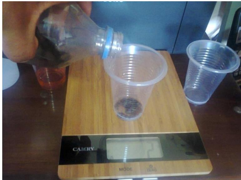
**Fig.15:** Graduación de la ceniza en la balanza analítica
