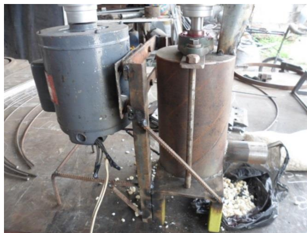
Ilustración 4. 15 Prototipo para obtener primeros parámetros técnicos de pulido
