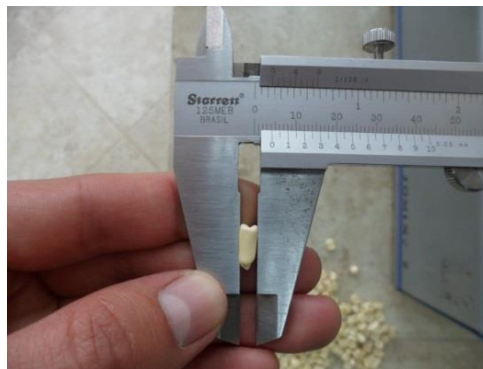
Ilustración 4. 19 Medición del espesor de un grano de maíz dimensión (c)
