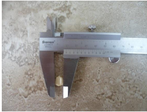
Ilustración 4. 18 Medición del ancho de un grano de maíz dimensión (b)
