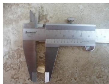
Ilustración 4. 17 Medición del largo de un grano de maíz dimensión (a)
