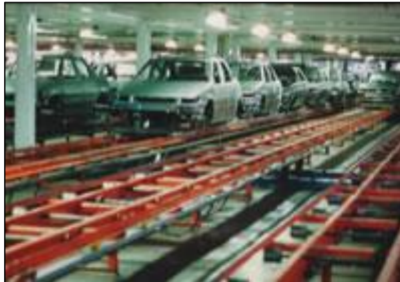
Figura 13. Transporte de línea continua por rodillo y cadena. Fuente: http://intraresa.com.ar/productos_transportadores.htm
