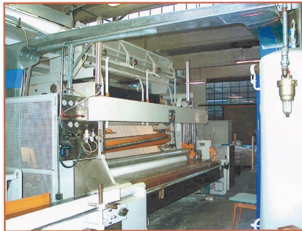
Figura 1-4. Sección de bobinado de la máquina de Fabio Perini
