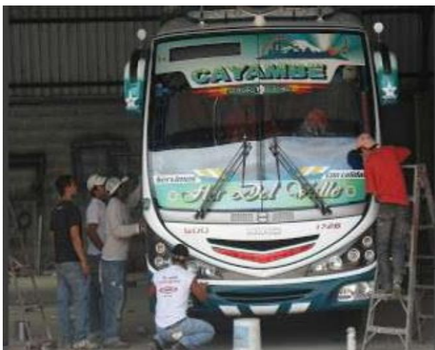
Fotografías 7: Ensamblaje básico de un bus (Instalación de accesorios) Autor: Vinicio Unda
