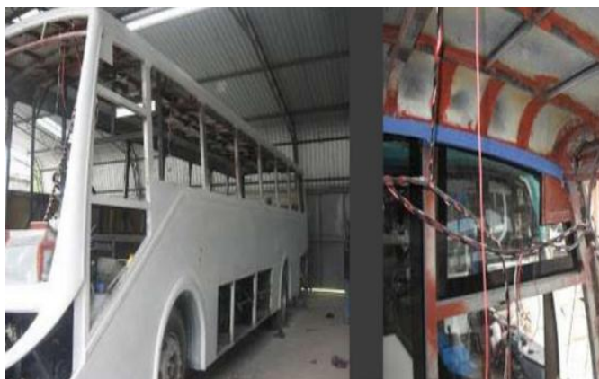
Fotografías 4: Ensamblaje básico de un bus (forrado) Autor: Vinicio Unda
