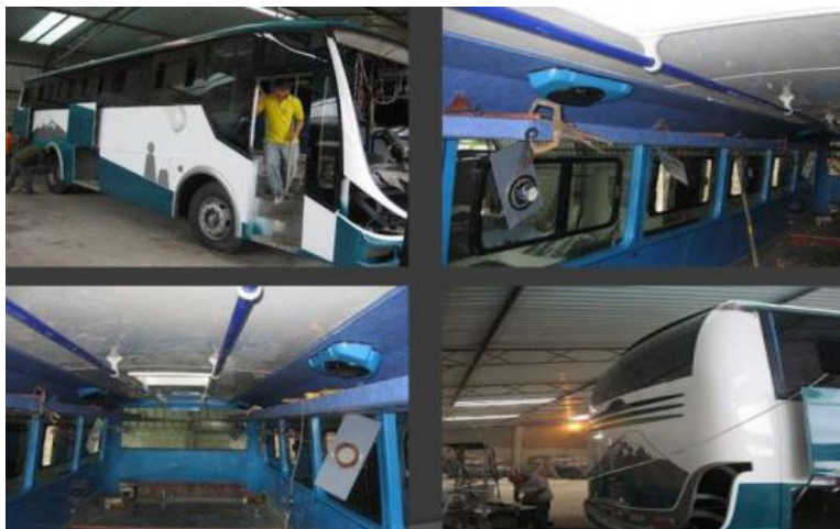
Fotografías 6: Ensamblaje básico de un bus (Instalación de accesorios) Autor: Vinicio Unda
