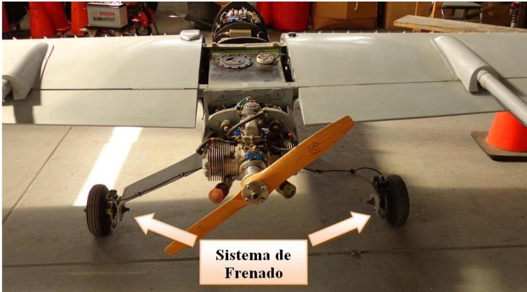
**Figura 4. 22: Sistema de Frenos**
