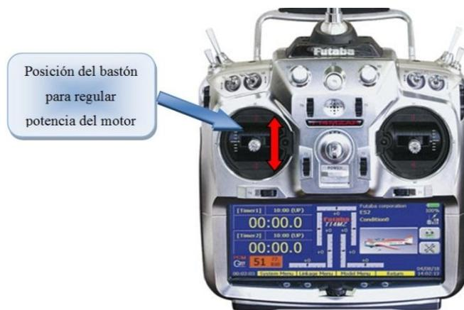
**Figura 4. 32: Bastón Acelerador**
